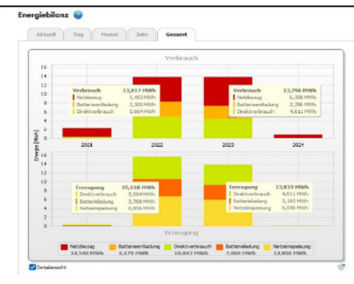
Seit 2021 wird ein erheblicher Teil des Stroms über die Photovoltaik-Anlage selber produziert (s. oben) und nur noch der Restbedarf zugekauft.
