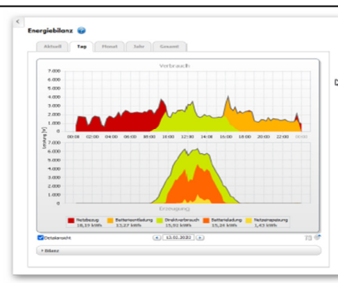
Die Abbildung zeigt die Funktion des Arealnetzes mit der Energiebilanz am 13.02.2022
